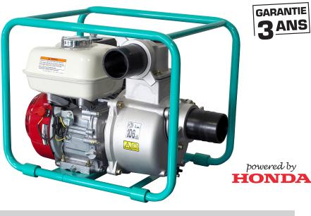
TP 65 H est adaptée aux transferts d'eaux claires et moyennement chargées en acceptant des particules allant jusqu'à 7.5 mm. Cette pompe est équipée de moteur professionnel HONDA haute performance, aptes à satisfaire également un usage plus soutenu. Des matériaux de hautes performances tels que la garniture mécanique en carbone céramique et le corps de pompe en fonte d'aluminium moulé injectée sous pression offrent une excellente fiabilité et longévité.
